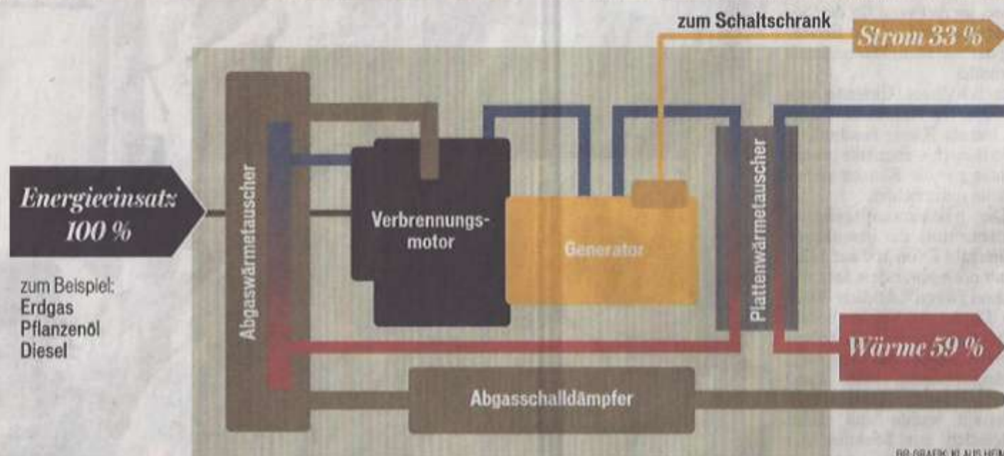
Funktionsweise eines Blockheizkraftwerk
